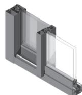
Luméal, la baie coulissante en aluminium à ouvrant caché. Sa ligne minimaliste assure un gain de **8 à 14 % de clair de vitrage** suivant son type de pose. **La masse d'aluminium est réduite (-35 %)** avec seulement 68 mm et 77 mm d'aluminium visible pour des performances thermiques élevées : **jusqu'à  $U_w = 1.2W/m^2.K$ ,  $Sw = 0.46$  et  $TLw = 0.65$ .**
